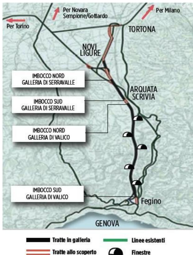
Il Terzo valico Genova – Tortona consta di **39 chilometri di gallerie su una tratta complessiva di 53 con termine delle opere previsto nel 2020.**
